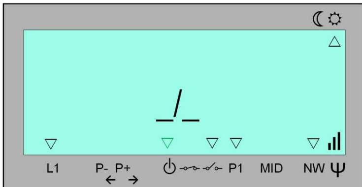
La flèche à côté de l'icône indique que le sectionneur est ouvert. La flèche clignotante à côté de l'icône indique que l'utilisateur peut mettre en service lui-même le sectionneur dans le compteur en appuyant pendant 5 secondes sur le bouton de navigation jaune-vert.
