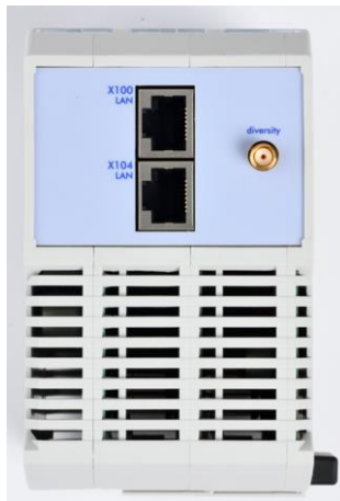
Aansluiting op RTU generatie 5X: onderzijde
