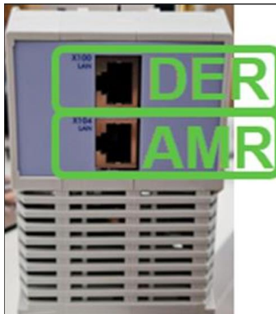
Aansluiting op RTU generatie 5E: onderzijde
