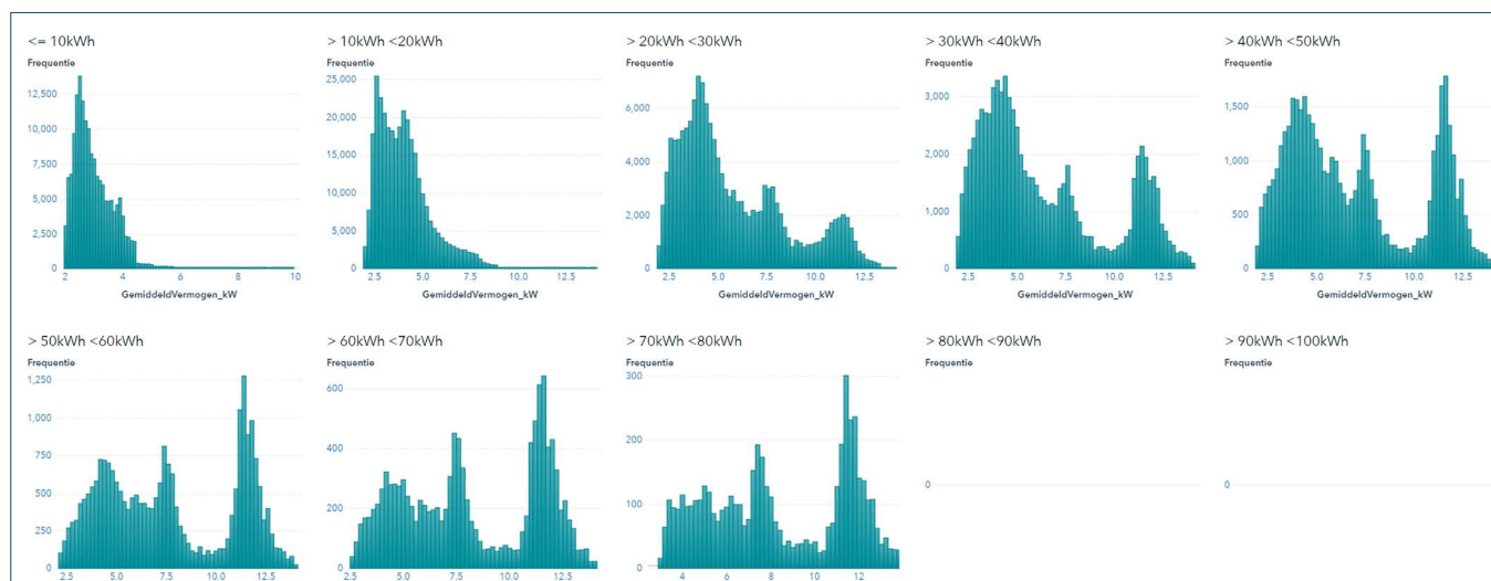
Figuur 3: Analyse van de geanonimiseerde data van de digitale meters – gemiddeld laadvermogen i.f.v. geladen energie (kWh)
